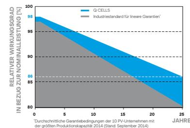
Mindestens 98% der Nennleistung innerhalb des ersten Jahres. Danach max. 0,5% Degradation pro Jahr. Mindestens 93,5% der Nennleistung nach 10 Jahren. Mindestens 86% der Nennleistung nach 25 Jahren. Alle Daten innerhalb der Messtoleranzen. Volle Produkt- und Leistungsgarantien entsprechend der jeweils gültigen Garantien der Q CELLS Vertriebsgesellschaft Ihres Landes.
